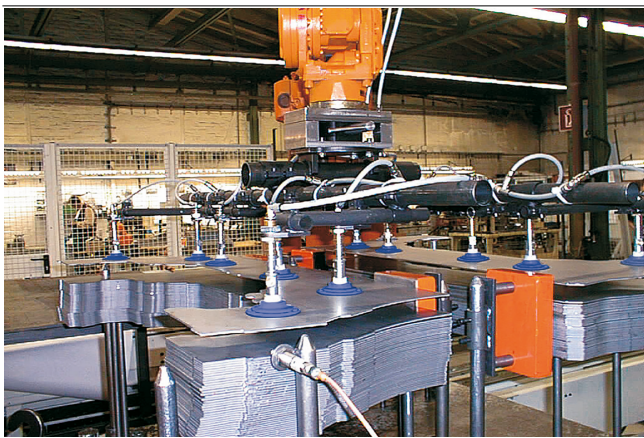
Ejemplo de montaje bielas elásticas FSTE-HD
